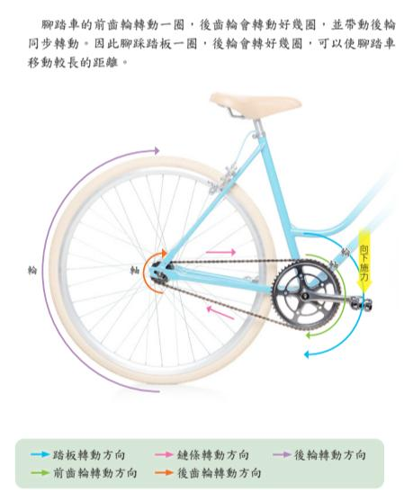
▲ 以腳踏車的構造，引導藉由齒輪鏈條組的操作，知道透過鏈條可以使前齒輪與後齒輪的轉動方向相同
